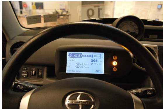
(d) Dashboard with charge/discharge control
